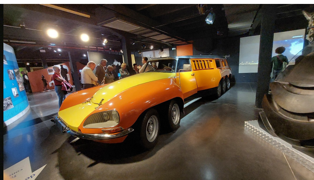
Le véhicule orange, le Mille pattes créé en 1972, sert à tester les pneus des poids lourds. © Caudalie Monlejacq
