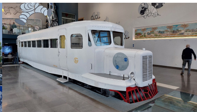
Un train sur pneu, la Micheline type 51 (dite coloniale) mise en service à Madagascar en 1952 sur la ligne Tamatave-Tananarive. © Caudalie Monlejacq
